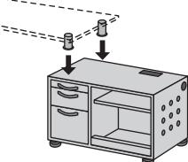
Containerstütze an gewünschter Position auf den Container aufsetzen, Fixierung erfolgt durch Antirutschbeschichtung **AR**
