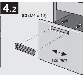
Demontage/Montage der Griffe mittels Schrauben **S1** (M4 x 25) bzw. **S2** (M4 x 12) von den Innenseiten der Schubladenblenden aus vornehmen
