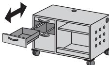
**Einbau:** Schublade von oben auf die voll ausgezogenen Führungsschienen auflegen **D** (ca 10 cm weiter vorn als Originalstellung); Schublade mit Führungen einschieben bis Rastklick erfolgt **E** **Abb. 9.2**
