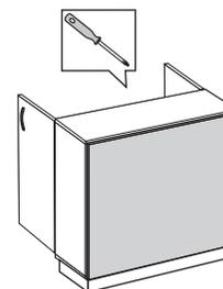
Sichrückwand mit Hilfe einer zweiten Person durch die Rückwand des Schrankkorpus' von innen her verschrauben (4 x 30 SK, selbst-schneidend),
