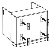
Um eine plane Auflage der Sichrückwand am Korpus zu garantieren, sind an der Schrankrückwand Distanzstreifen aufzu-kleben.
