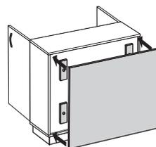
Sichrückwand mit den innenseitig ange-brachten Positionierungsleisten in den um-laufenden Rand des Korpus' einpassen und in dieser Position halten.
