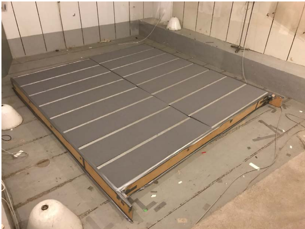
Foto des 42 mm Gabriel OKA.DeskTop-Akustikpaneels mit Einbautiefe 200 mm im Hallraum
