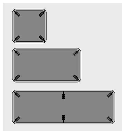
FüÙe mit Winkel nach auÙen zeigend auf den Bohrungen positionieren und mit jeweils 6 Schrauben in den Gewindebuchsen auf der Unterseite montieren.
