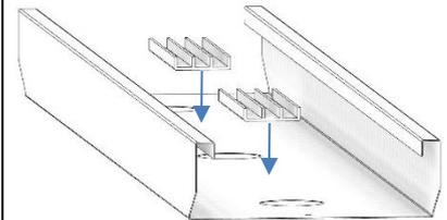
2. Montage- Kabelschlange Cube
