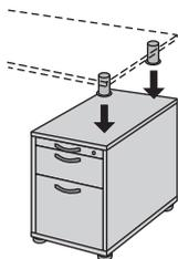
Containerstütze an gewünschter Position auf den Container aufsetzen, Fixierung erfolgt durch Antirutschbeschichtung **AR**
